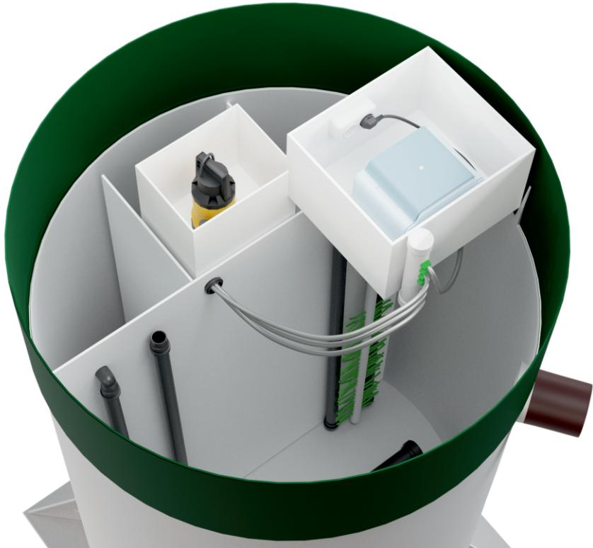
**1 блок:** Зона нитрификации - первичный отстойник. Механическая очистка - удаление взвешенных частиц (мусора, песка и т.д.), сбраживание ила, при котором извлекается легкоокисляемая органика, необходимая для процесса денитрификации. Аэробный процесс осуществляется бактериями, которые окисляют азот аммонийный до нитратов.
